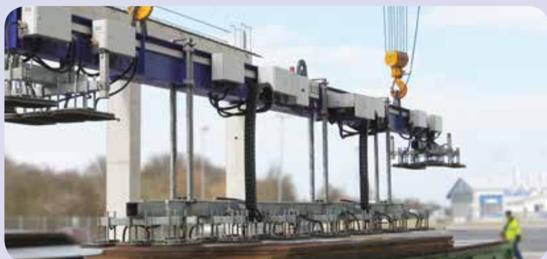
Тяжеловесное устройство грузоподъемность 32000 кг.
