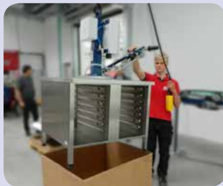
Выгрузка со стеллажей устройством на батарее
