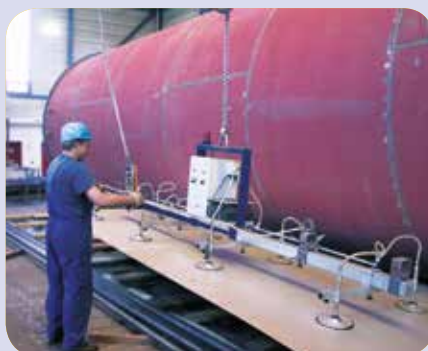
Независимое от сети устройство для листов весом до 1.000 kg
